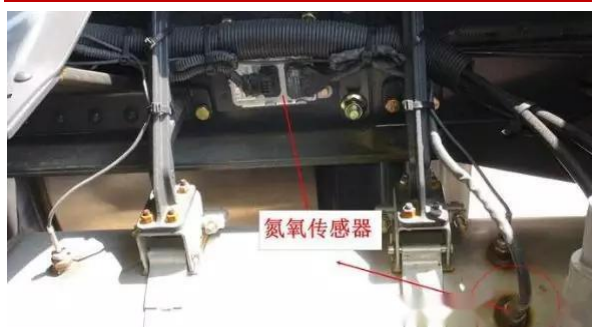
图 36：柴油车氮氧传感器安装位置图示
